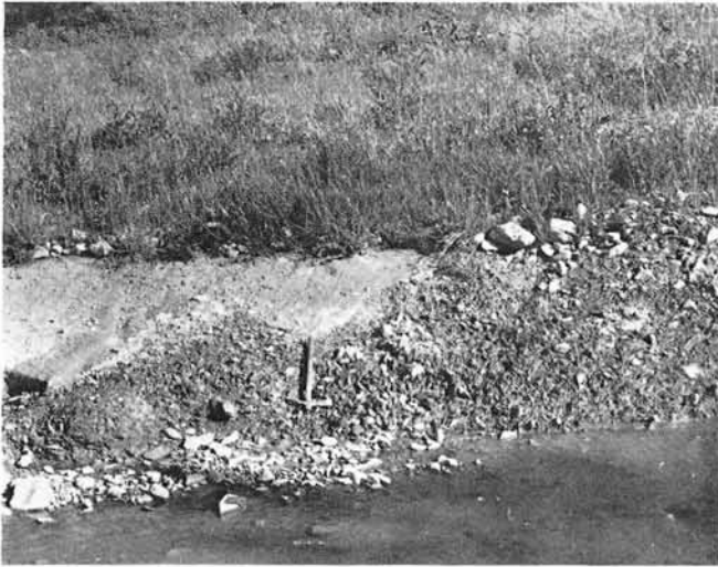
Fig. 10 - Ghiaie e sabbie argillo-siltose giallognole ad andamento irregolare (tratto 24 della colonna stratigrafica).
