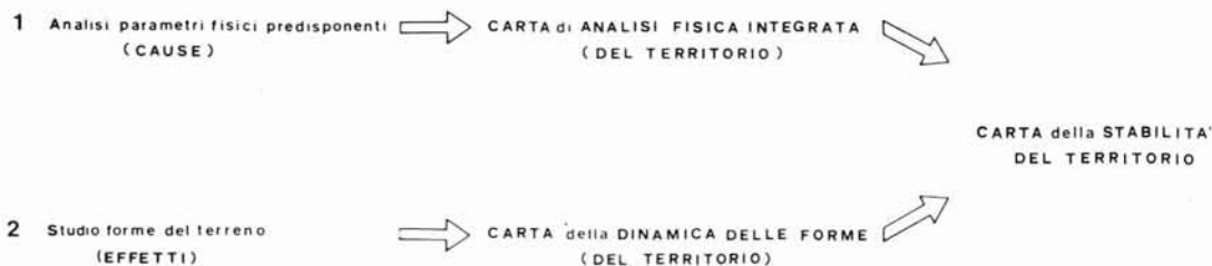
Fig. 1 - Schema dei due metodi per la realizzazione della carta della stabilità del territorio.
