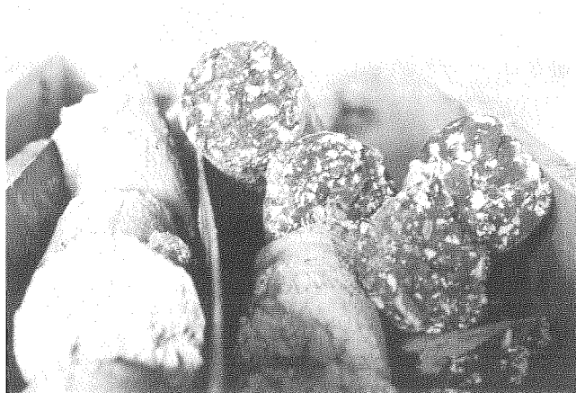
FIG. 7 - Depositi di detriti calcarei con clasti spigolosi e/o arrotondati di dimensioni da centimetriche a decimetriche immersi in matrice bruno-rossastra. Dettaglio di una delle carote.
