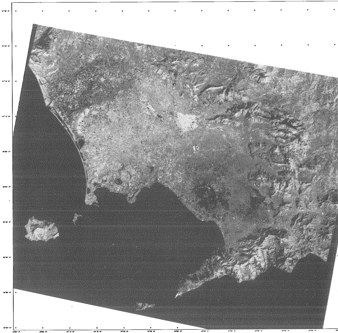
FIG. 3 - Landsat TM banda 5. Edge enhancement dell'immagine della Piana Campana e zone limitrofe realizzato con l'uso di un filtro non-direzionale. Al filtraggio, effettuato utilizzando un fattore peso di 0,2, è stato associato ad uno stretching del tipo equalizzazione , con lo scopo di ottenere un generale miglioramento del contrasto prima dell'applicazione del filtro.
