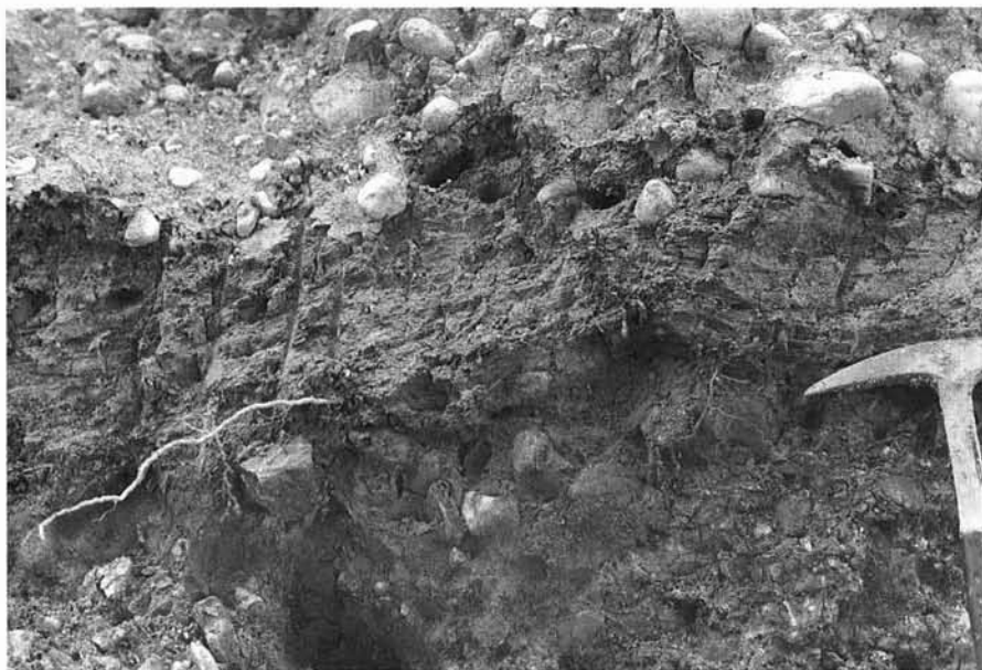
FIG. 16 - Camerata (Izzalini). Conglomerato con ciottoli evoluti e matrice sabbioso-siltosa del «complesso detritico superiore».
