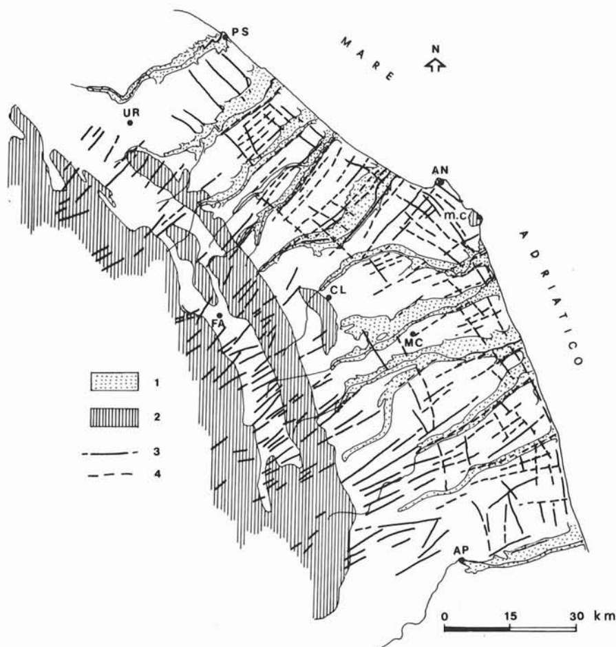
FIG. 4 - Principali lineamenti tettonici trasversali riconosciuti nella regione marchigiana. 1) pianure alluvionali terrazzate; 2) dorsali carbonatiche meso-cenozoiche; 3) faglie; 4) faglie probabili o non ben localizzate nella sequenza plio-pleistocenica.
