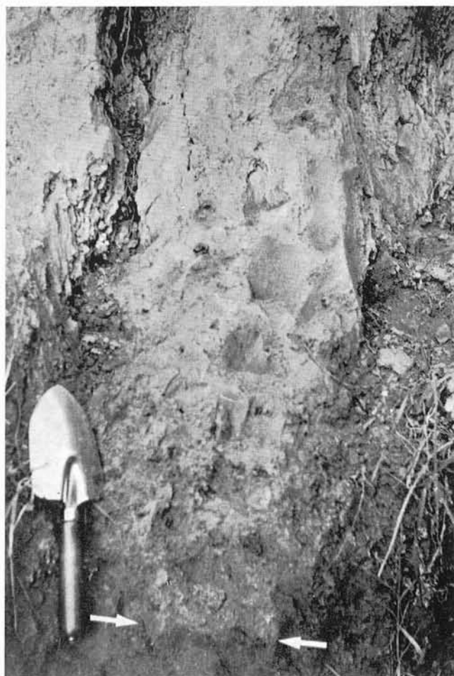
FIG. 21 - Aspetto dei depositi limoso-sabbiosi del Complesso B affioranti al margine meridionale del Settore Settentrionale: alla loro base sono presenti i depositi limoso-argillosi dell'Unità A 2 ; il limite (indicato dalle frecce) appare netto e ondulato nel dettaglio. Affioramento lungo la Strada Statale 29, 50 m a Sud di C. Nova di Beffa (Poirino).
