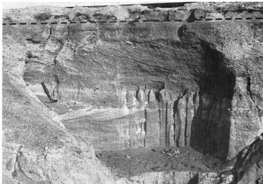
FIG. 4 - « Sabbie e Ghiaie Inferiori ». Si distingue una parte inferiore, a grana fine, con lamine variamente inclinate ed una parte superiore a grana più grossolana con clinostratificazione immergente a SW (destra nella foto). All'estremità superiore è visibile il contatto (a tratteggio) coi termini delle soprastanti « Sabbie e Ghiaie Superiori ». Località: scavi per la centrale nucleare.
